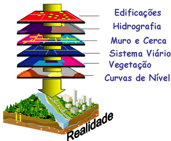
**FIGURA 2:** exemplo de base cartografia preparada para geoprocessamento
