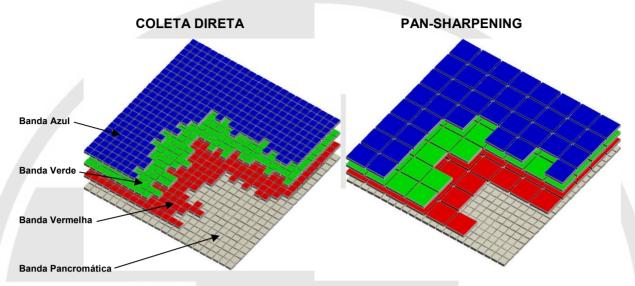
As figuras mostram esquematicamente como são obtidas as imagens multiespectrais de forma direta e com o pan-sharpening.
