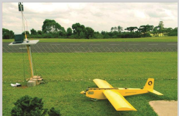
RPAS SIMEPAR / ESTEIO com payload de 2 kg e sensor de pequeno formato.
