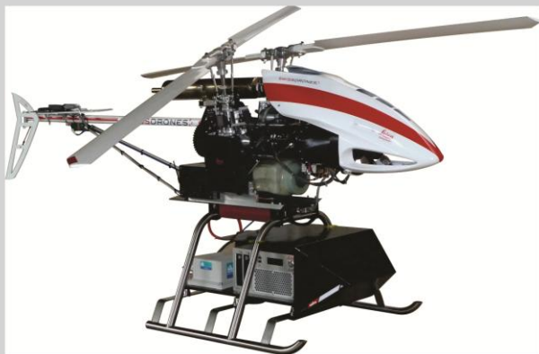
RPAS Swiss Drones com payload de 35 kg e sensor LEICA RCD30 de médio formato.
